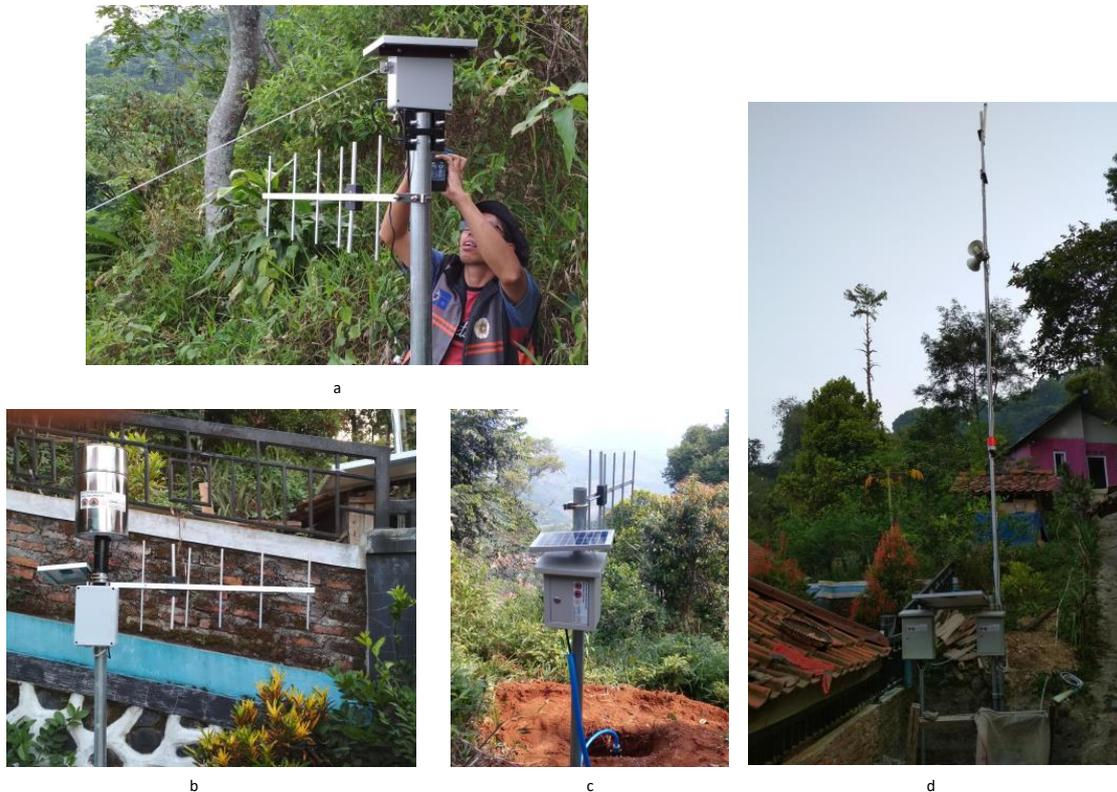
**Gambar 3.1.** a. Extensometer, b. Penakar Hujan, c. Tiltmeter, d. Server dan Warning Sistem [2]
